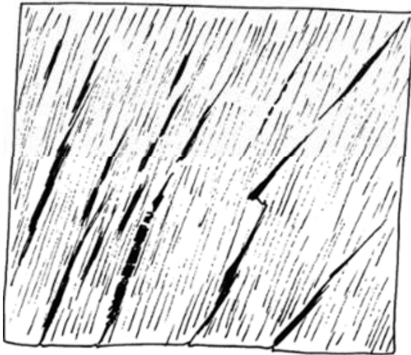
Dibujo N° 16 . Presencia de grietas en la madera
