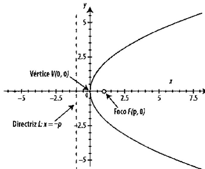
Figura 7.6. Parábola en posición estándar abierta hacia la derecha con  $p = 1$ . Vértice:  $V(0, 0)$ ; foco:  $F(1, 0)$ . Ecuación  $y^2 = 4px$ .
