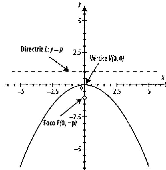
Figura 7.9 Parábola en posición estándar abierta hacia abajo con  $p = 1$ . Vértice:  $V(0, 0)$ ; foco:  $F(0, -1)$ ; ecuación:  $x^2 = -4py$ .
