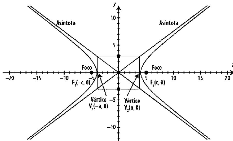
Figura 7.33 Hipérbola horizontal con focos sobre el eje x. En este ejemplo se eligió  $c = 5$ ,  $a = 4 \Rightarrow b = 3$ .
