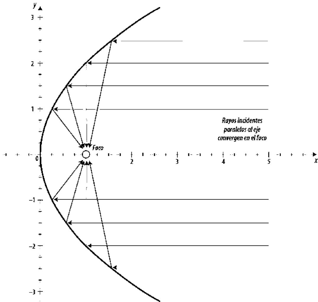
Figura 7.18 Rayos incidentes paralelos al eje de la parábola convergen en el foco.
