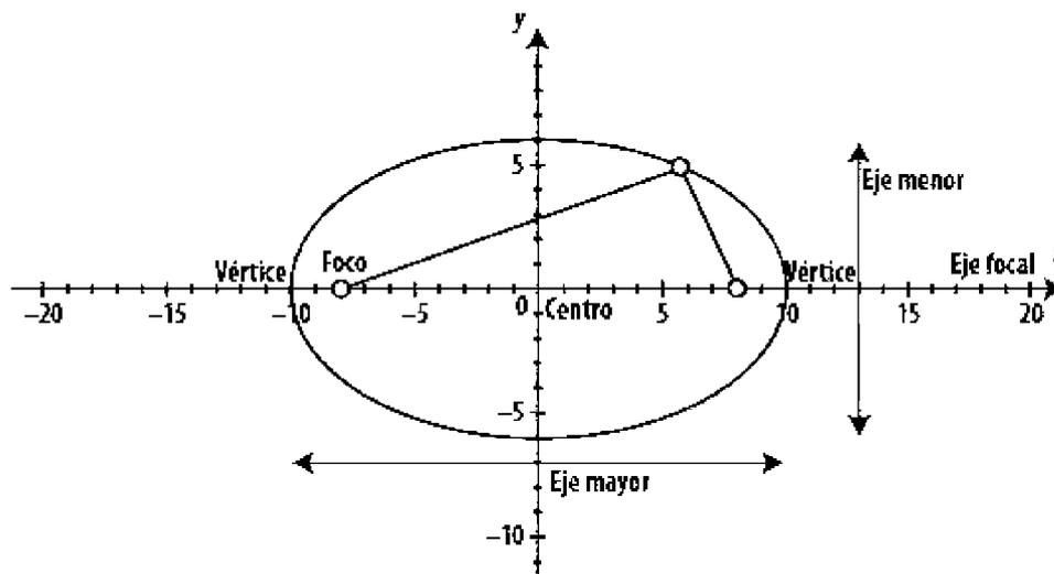
Figura 7.20 Elementos de una elipse.
