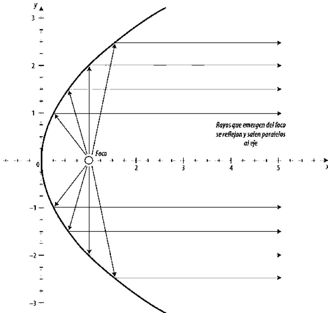
Figura 7.19 Rayos que emergen del foco que se reflejan en la parábola y salen paralelos al eje de simetría.
