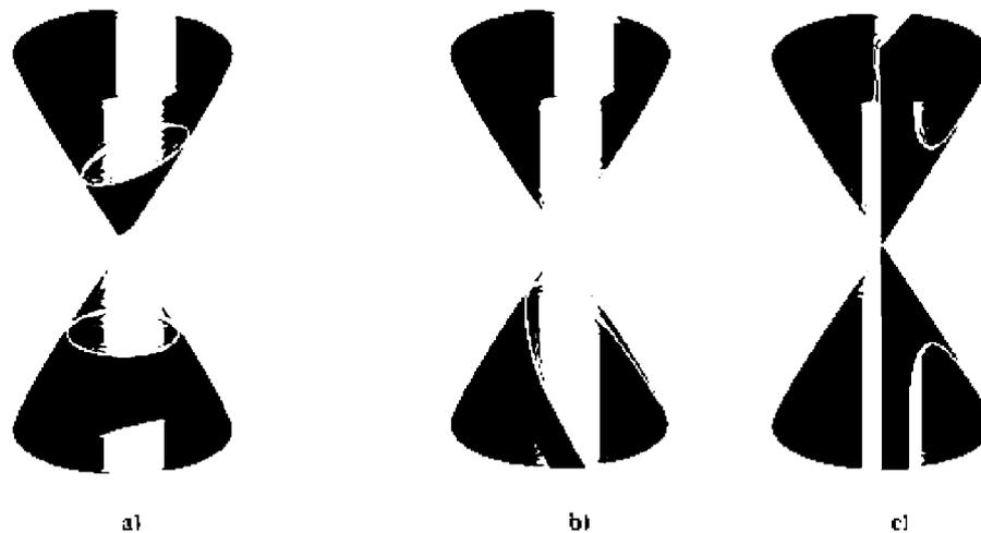
Figura 7.1 Generación de: a) una circunferencia y una elipse, b) una parábola y c) una hipérbola, cortando un cono con un plano de acuerdo al ángulo de inclinación del plano respecto del eje del cono.
