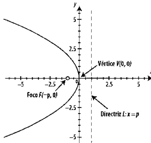
Figura 7.7 Parábola en posición estándar abierta hacia la izquierda con  $p = 1$ ; vértice:  $V(0, 0)$ ; foco:  $F(-1, 0)$ ; ecuación:  $y^2 = -4px$ .
