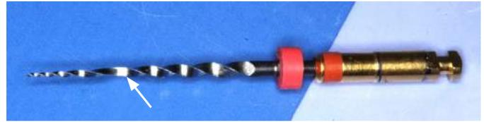
Figura 7. El estrés de torsión hace que se sobrepase el límite de elasticidad del metal y se produce una deformación plástica de la lima señalada por la flecha amarilla.
