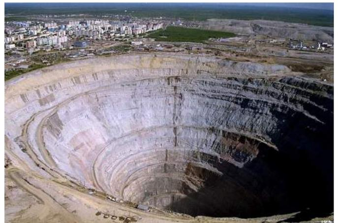
**Figura 22.** La mina de diamantes en la Siberia Central de Rusia es un buen ejemplo de cómo se puede acceder con facilidad a grandes profundidades abriendo ampliamente la entrada a ella.
