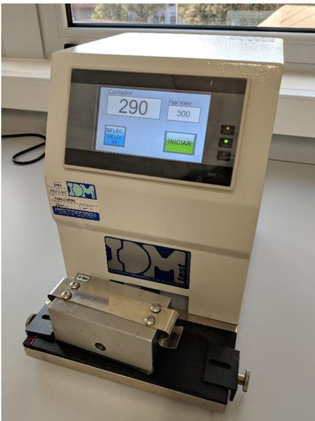
*Grip comb test* en un frasco de vidrio lacado
