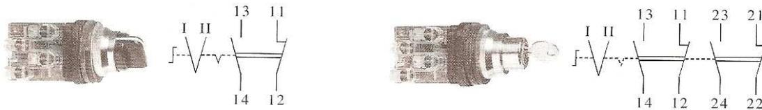
**Fig. 5.3** SELECTORES DE DOS POSICIONES CON CONTACTOS SOLAPADOS
