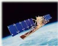
Un sensor de radar activo, ya sea aéreo o espacial, emite radiación de microondas en una serie de pulsos desde una antena.
