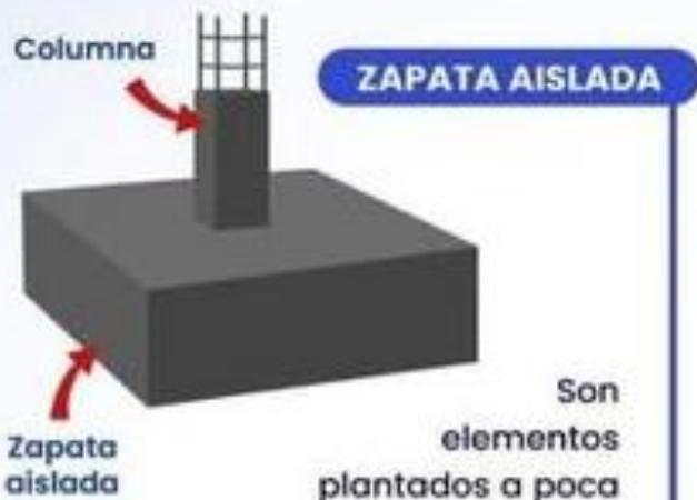
Son elementos plantados a poca profundidad y utilizados como elementos de cimentación debajo de las columnas.
