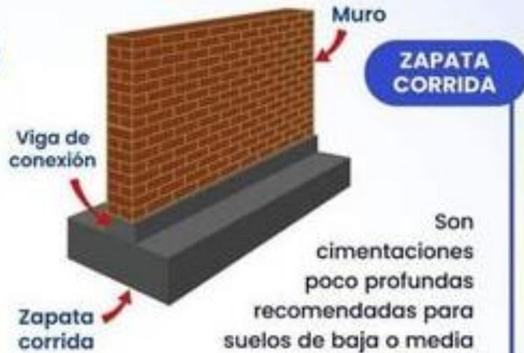
Son cimentaciones poco profundas recomendadas para suelos de baja o media compresibilidad y generalmente soportan las cargas de la estructura a través de los muros.
