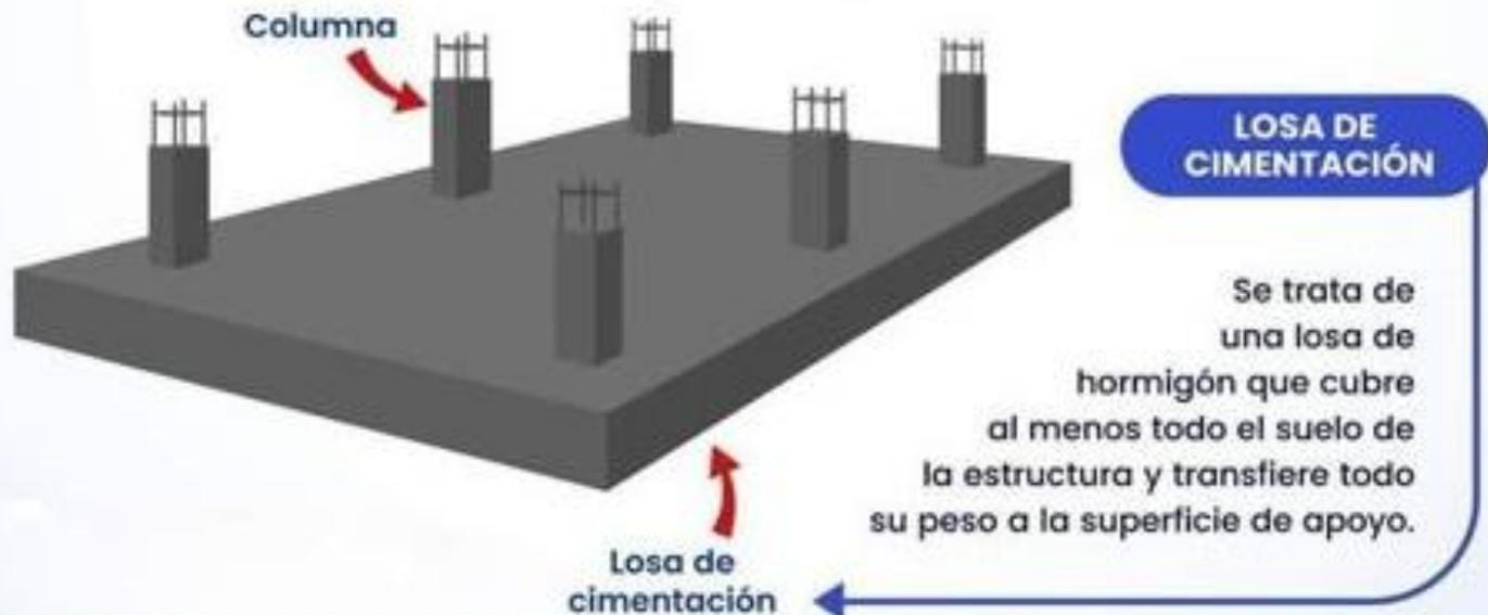
Se trata de una losa de hormigón que cubre al menos todo el suelo de la estructura y transfiere todo su peso a la superficie de apoyo.
