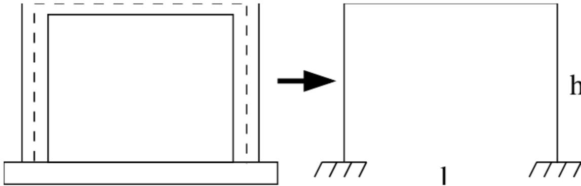
Una estructura es un agrupamiento elástico estable, compuesto por un número finito de elementos unidos entre sí mediante un número finito de juntas, uno de cuyos números es arbitrario.
