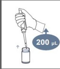
Transfiera 200 µL de diluyente detector usando una pipeta
