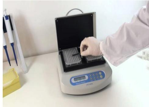
Colocar en un rotador o agitador orbital a 170 rpm a temperatura ambiente durante 30 minutos .
