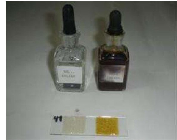
Montaje entre lámina y laminilla con solución salina y yodada
