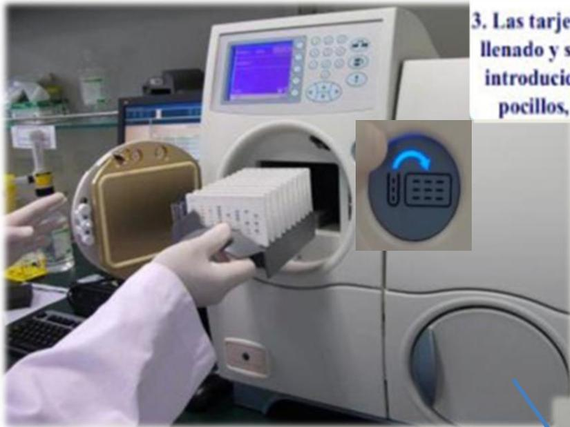
3. Las tarjetas se colocan en el módulo de llenado y sellado donde la muestra será introducida por succión al vacío en los pocillos, sellando después la tarjeta
