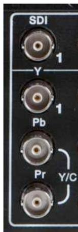
Imagen 2 - (1.2.1-Conectores de entradas a/v)
