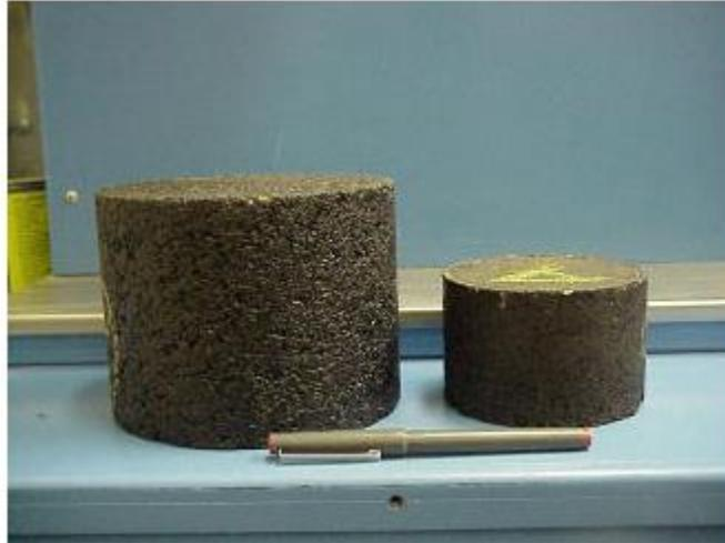
*Muestra de compactador giratorio Superpave vs compactador Hveem/Marshall*
