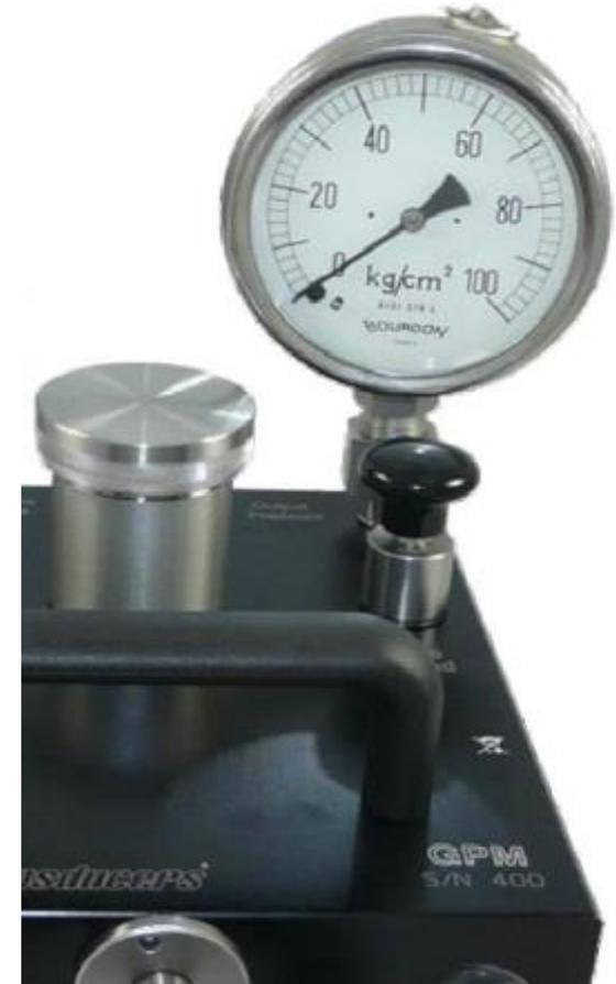
Un **manómetro** es un dispositivo para medir la presión de los gases distintos a los de la atmósfera en recipientes cerrados.
