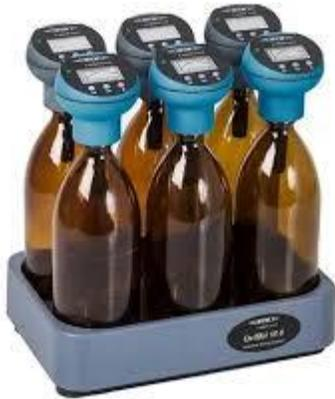
Dispositivo utilizado para medir el contenido de oxígeno disuelto en agua en ppm
