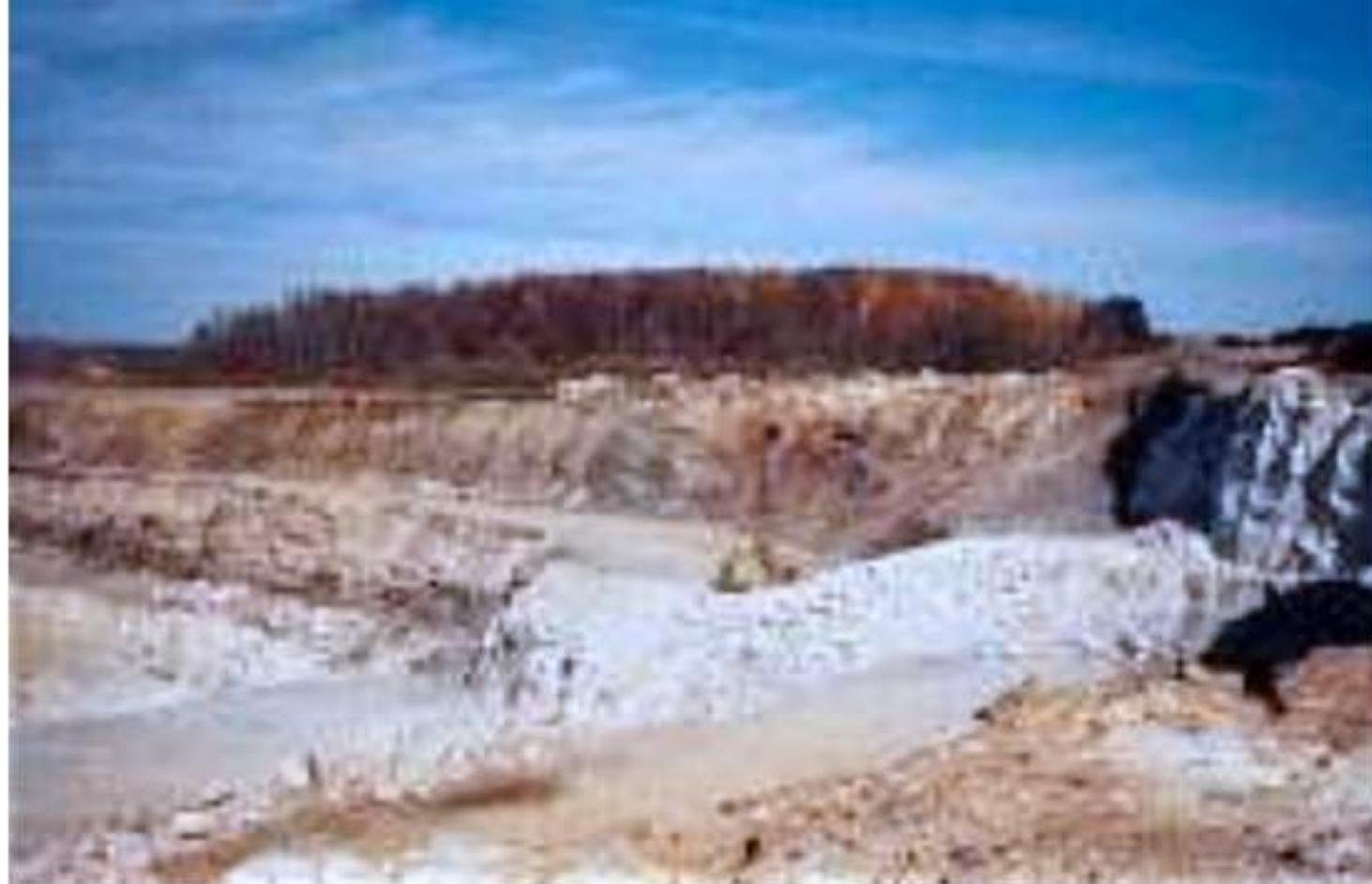
**Caliza, una de las principales materias primas, provee el calcio para la producción de cemento y se extrae cerca de la planta de cemento.**
