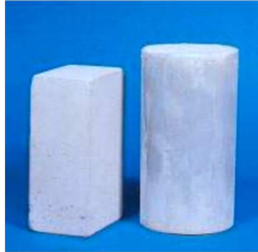
**Piedra de cantera de la isla de Portland (que inspiró el nombre de cemento portland) cerca de un cilindro del concreto moderno. (IMG12472)**
