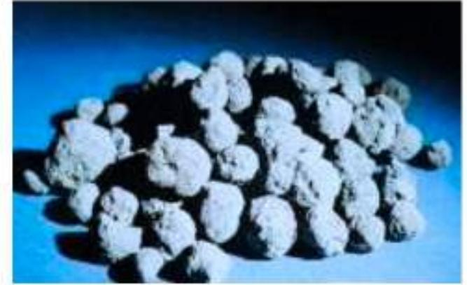
**El clinker de cemento portland se forma por la calcinación en el horno del material crudo calcáreo y sílice. Este clinker específico tiene un diámetro de 20 mm (3/4 pulg.) (IMG12434)**
