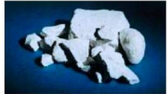
**El yeso, la fuente de sulfato, se muele juntamente con el clinker para formar el cemento portland. El yeso ayuda a controlar el tiempo de fraguado, las propiedades de contracción (retracción) por secado y el desarrollo de resistencia. (IMG12489)**
