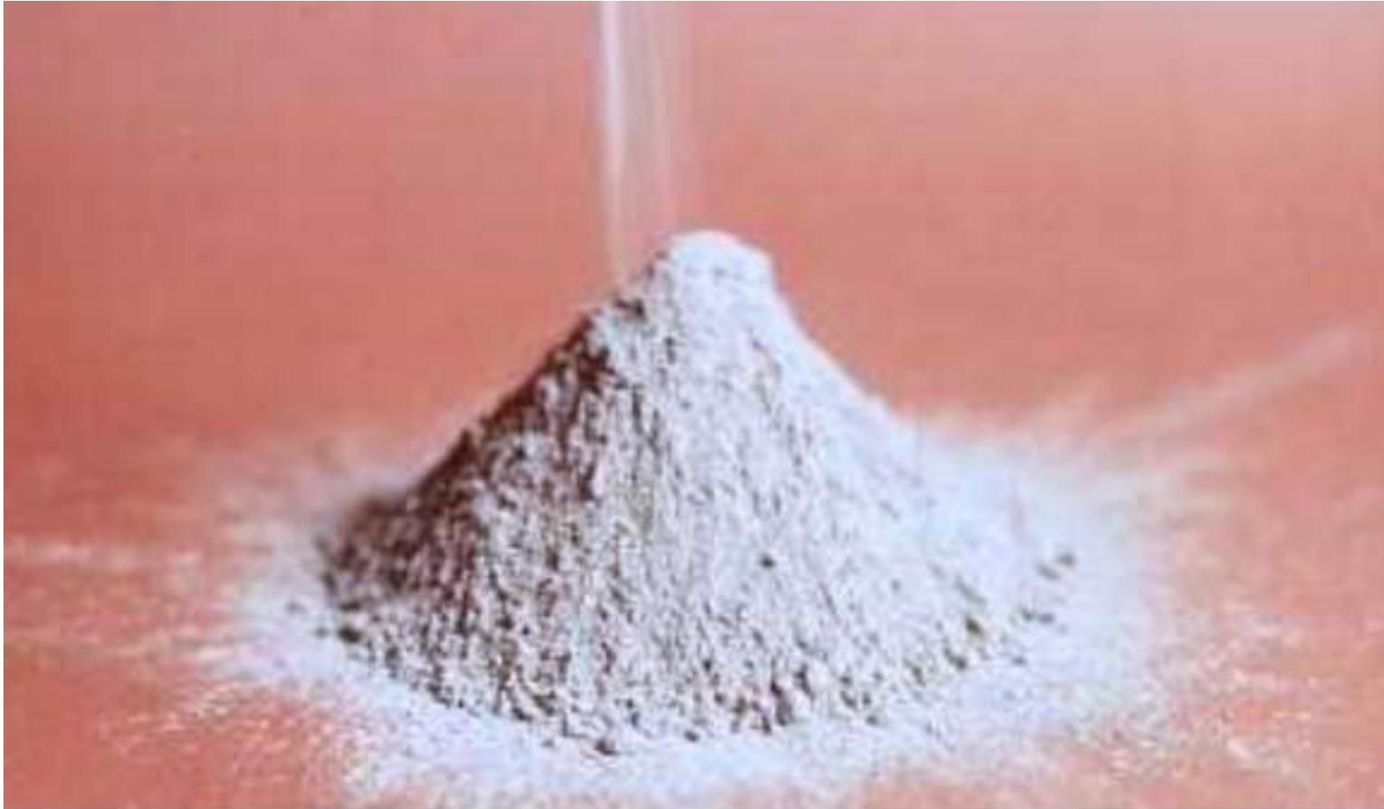
**El cemento portland es un polvo fino que cuando se mezcla con el agua se convierte en un pegamento que mantiene los agregados unidos en el concreto. (IMG12628)**
