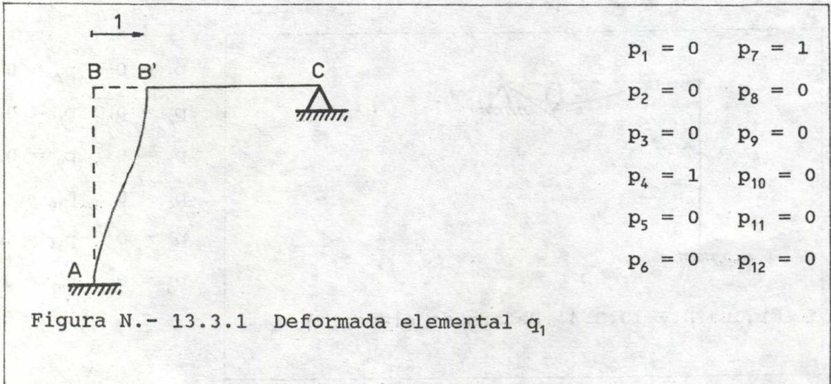
Figura N.- 13.3.1 Deformada elemental  $q_1$
