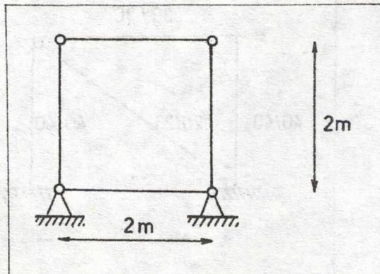
8.- Determinar la matriz de rigidez por ensamblaje directo del marco plano siguiente. Los dos elementos tienen la misma sección transversal, y en ellos se cumple que:
