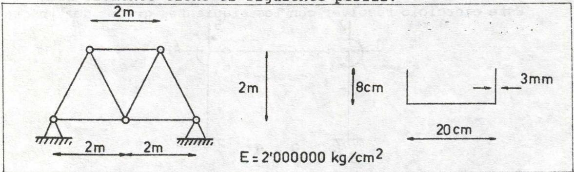
7.- Indicar si la armadura siguiente es estable o inestable usando la matriz de rigidez de la estructura. Igual perfil al anterior.
