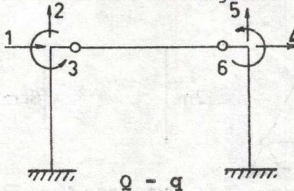
10.- Determinar la matriz de rigidez por ensamblaje directo de la siguiente estructura.  $E = 2'100000 \text{ T/m}^2$
