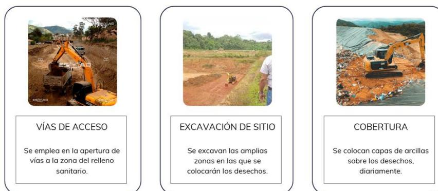
Ilustración 99: Funciones de la excavadora
