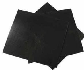
Ilustración 104. Geomembrana Bituminosa
