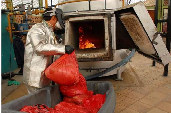
*Ilustración 125 - Incineración de residuos sólidos.*
