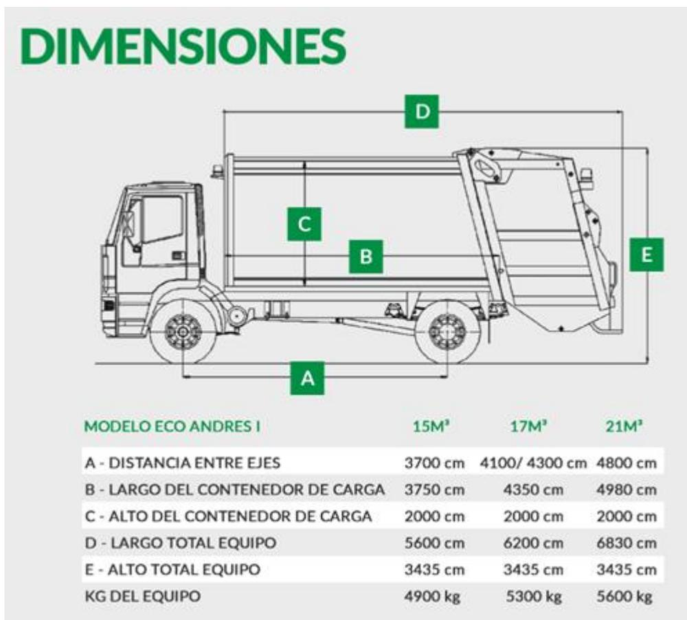
*Ilustración 59. Especificaciones técnicas de camión carga trasera.*
