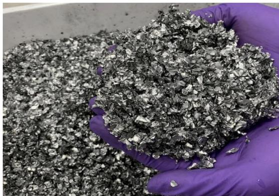
*Ilustración 44 - Pretratamiento mecánico de las baterías.*
