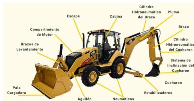
Ilustración 100: Partes de la retroexcavadora
