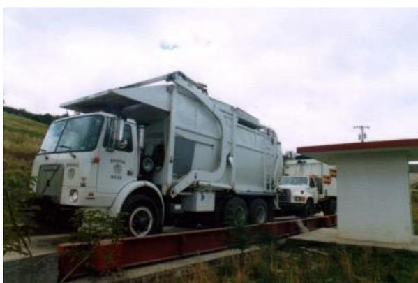
*Ilustración 92 - Balanza registradora*
