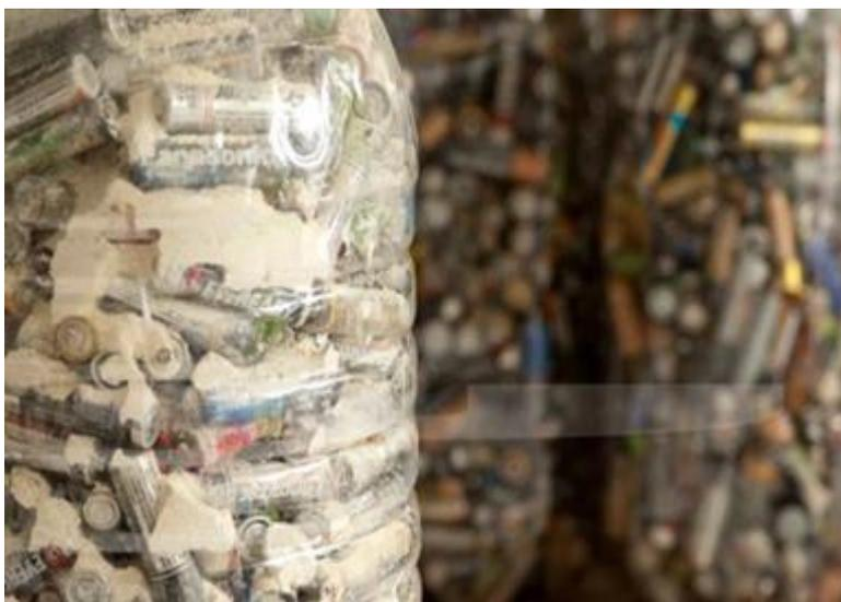
*Ilustración 49 - Confinamiento de baterías*
