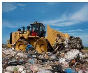
*Ilustración 96 - Compactador con ruedas metálicas*
