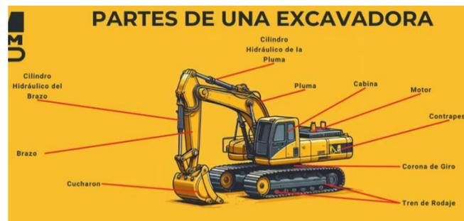
*Ilustración 98: Partes de la excavadora*
