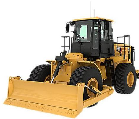
*Ilustración 94 - Clasificación de Bulldozer con llantas.*
