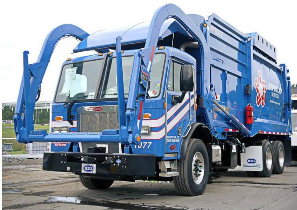
*Ilustración 63. Camion recolector carga frontal.*
