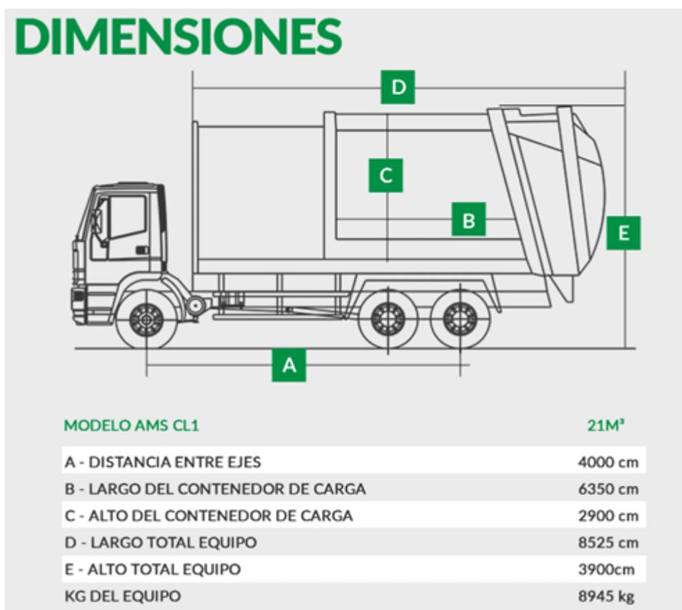
*Ilustración 61. Dimensiones camión carga lateral.*
