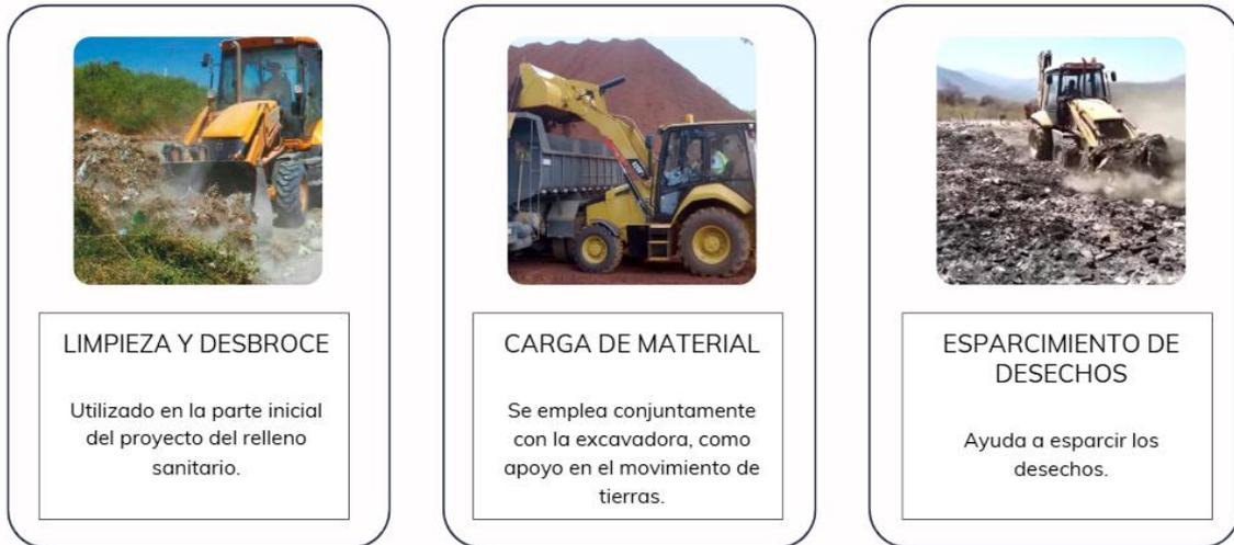
*Ilustración 101: Funciones de la retroexcavadora en rellenos sanitarios*
