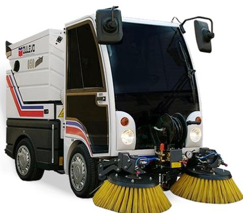
*Ilustración 66 - Ejemplo de barredora mecánica.*
