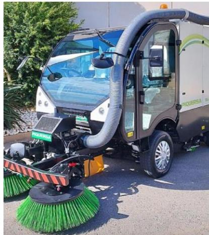
Ilustración 68 - Ejemplo de barredora de aspiración.
