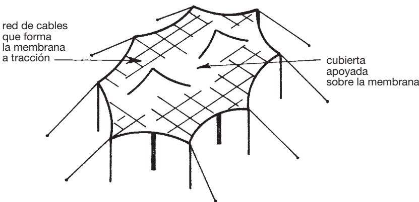
ESTRUCTURA DE MEMBRANA A TRACCIÓN
