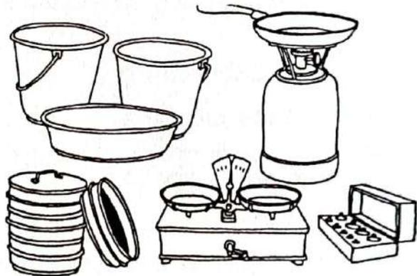
Cada criba habrá retenido una cierta cantidad de material, el cual es secado en la estufa o la hornilla, luego se pesa con exactitud y se registra el peso. Las partículas finas que se encuentran en el fondo del recipiente son una mezcla de limo y arcilla, la cual no puede ser separadas con las cribas. Esta es llevada a la siguiente prueba.
